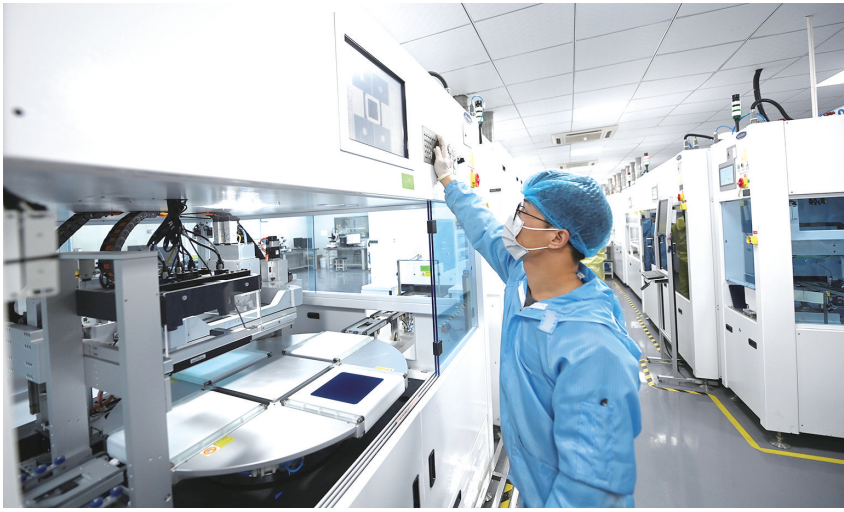
在杭州市富阳区春江街道富春湾新城的杭州正银电子材料有限公司的研发实验室内,自动化设备在进行光伏板的丝网印刷(3月22日摄)。
