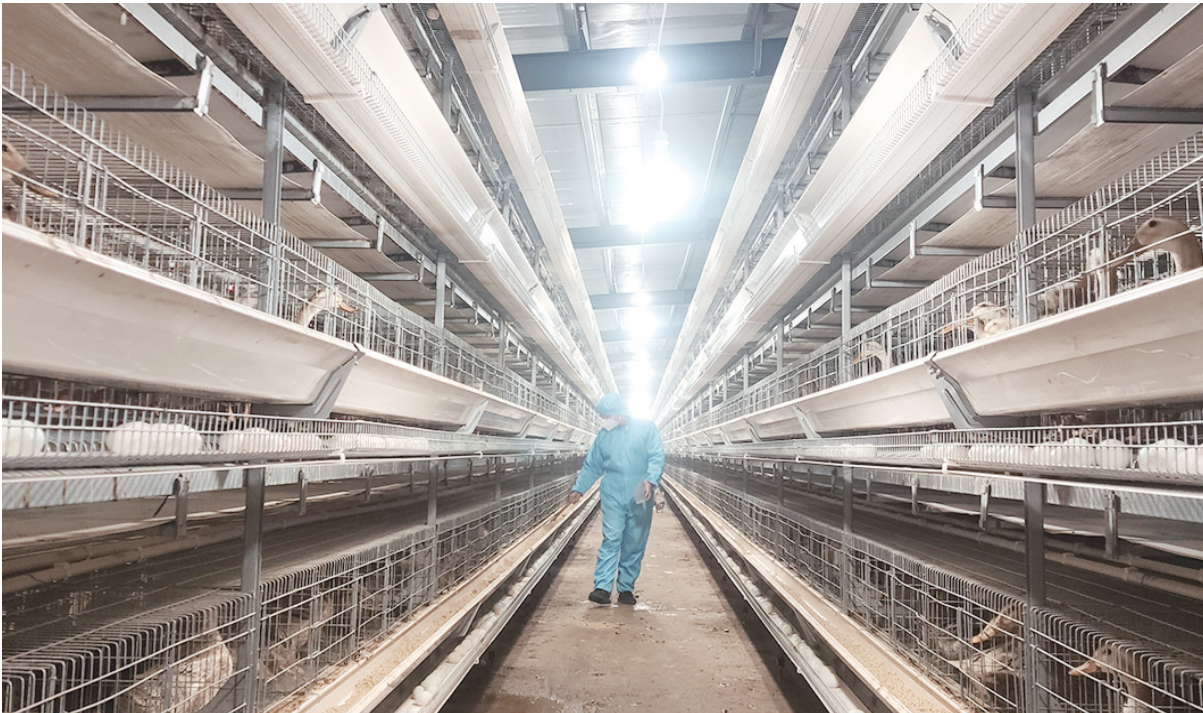
大城关笼养蛋鸭大棚的排风控温、上料供水、清粪集蛋等流程全部实现了自动化，图为饲养员正在大棚内查看蛋鸭生长情况。
