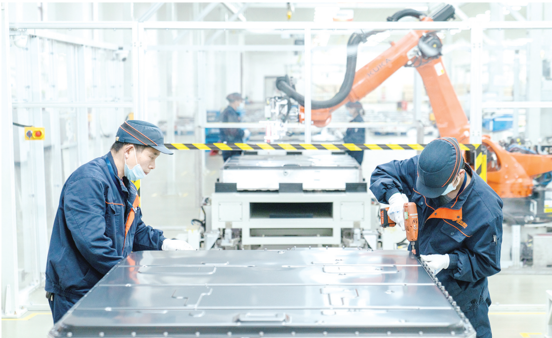
12月20日,桐城国轩新能源有限公司pack车间内,工人正在安装电池包壳体。
