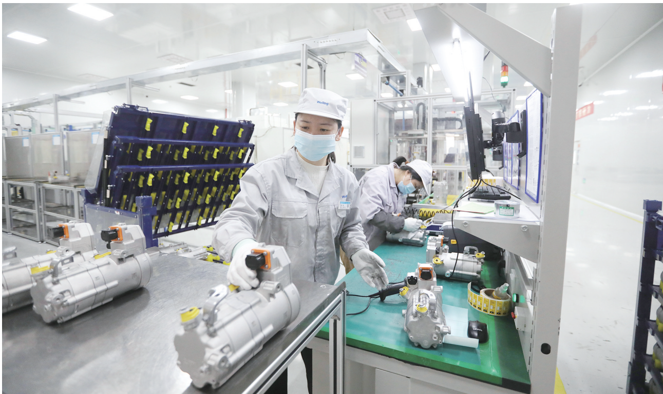
美的威灵新能源汽车零部件生产车间，一台台压缩机正在下线。
