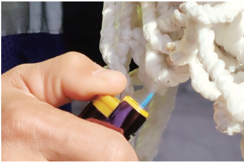
在火苗的“舔舐”下，防坠网仅有轻微灼痕。 全媒体记者 江露露 摄
