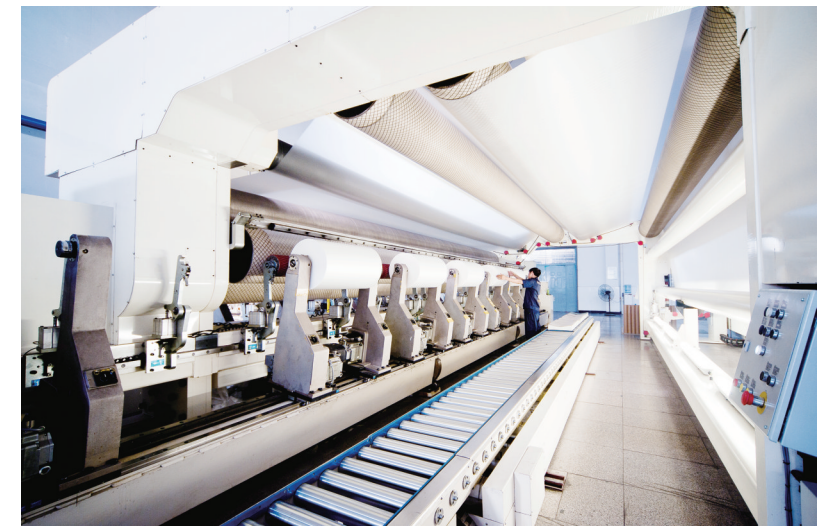
安徽金田高新材料股份有限公司车间,工人在着手更换大膜卷作业。
