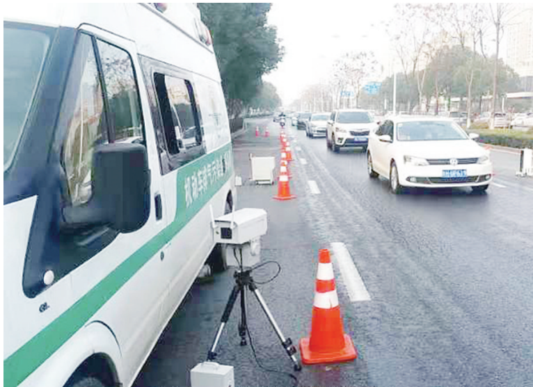
图为移动式遥感监测设备在路上检测机动车尾气。
