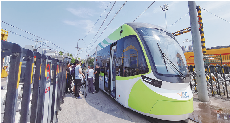
这是在中车株洲电力机车有限公司拍摄的高能量型超级电容有轨电车（8月22日摄）。 新华社发
