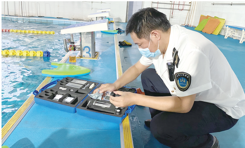
卫生执法人员对游泳池的水质进行现场快速检测。
