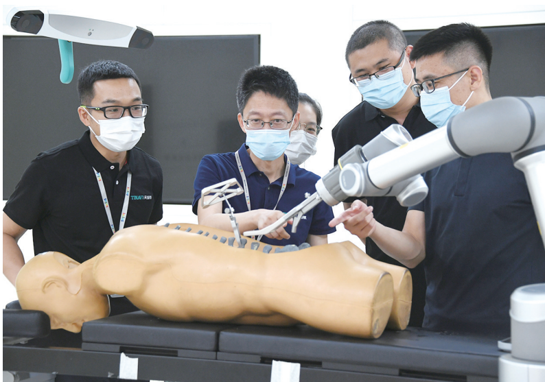
在北京天智航医疗科技股份有限公司实验室，刘铁昌（左二）与同事讨论骨科手术机器人机械臂在使用中的优化方案（8月4日摄）。新华社发
