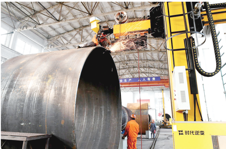
1月17日,大观区盈创公司员工正在焊接大型钢管。
