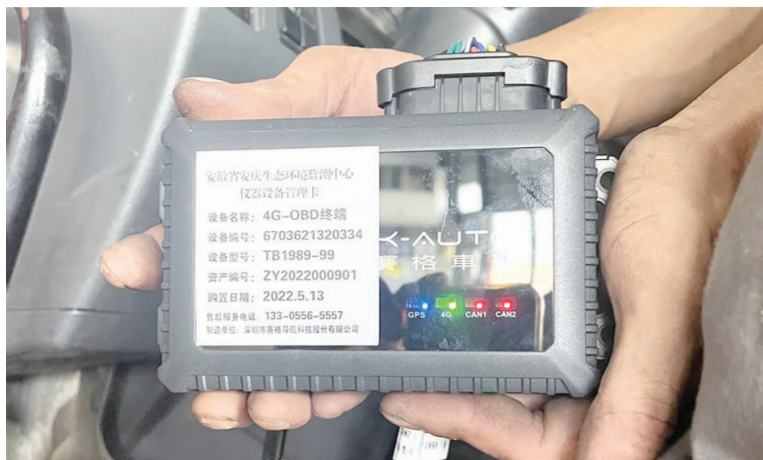
图为车辆上安装的“黑匣子”。全媒体记者 白萍 摄
