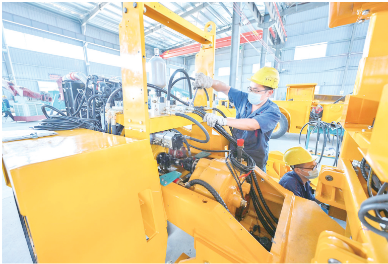
图为安庆经开区安徽佳乐建设机械有限公司装备车间。该企业自主研发的智能化混凝土湿喷台车关键技术研发与应用获得省科技重大专项。 资料图片
