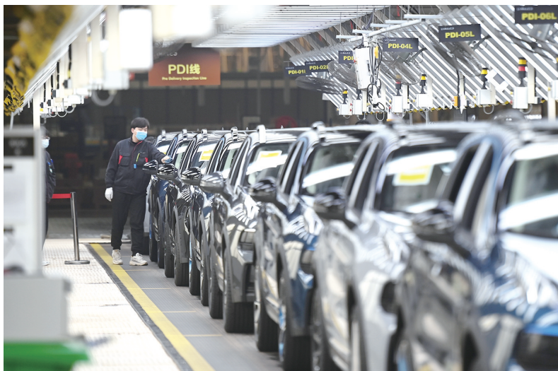
1月5日，工人在领克汽车浙江余姚工厂总装车间进行下线前的检查工序。 新华社发
