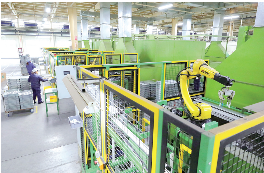
12月18日，在安庆经开区安庆雅德帝伯活塞有限公司生产车间内，机械手臂正在对活塞进行树脂印刷后下料检查。 全媒体记者 江胜 摄
