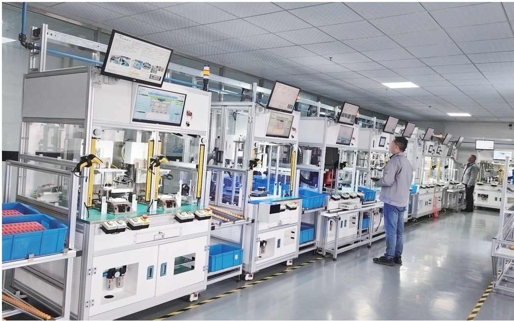
2月19日,安庆杰曼汽车科技有限公司生产车间内,新能源汽车电子水泵自动生产线正在试生产。
