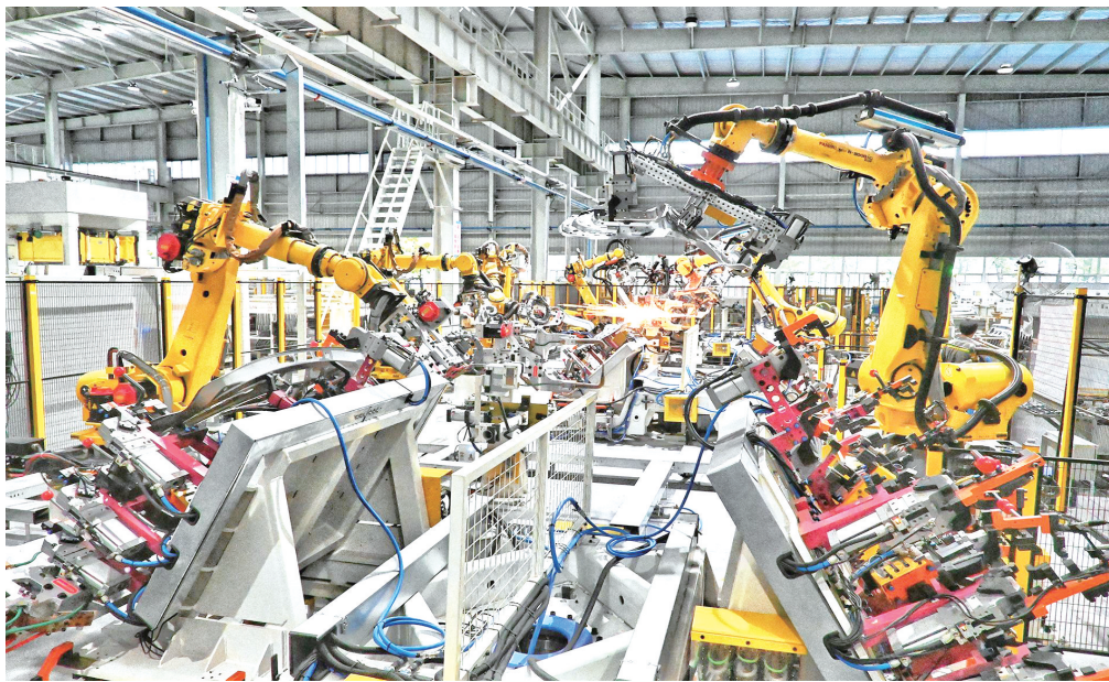
8月15日,安庆常庆汽车部件有限公司机器人自动化生产线正在生产汽车零部件产品。该生产线今年3月28日投产,目前自动化率超过90%。
