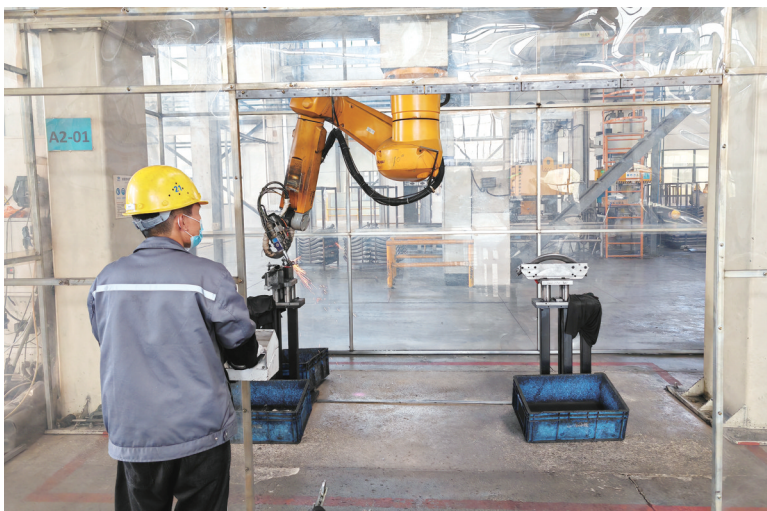
思明公司车间内工业机器人正在焊接。
