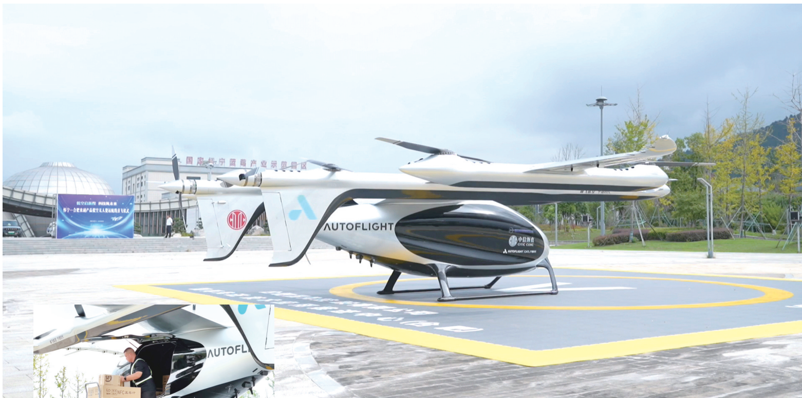
◀工作人员正在现场装货。 ▲2吨级大型货运eVTOL航空器。(图片源于视频截图)
