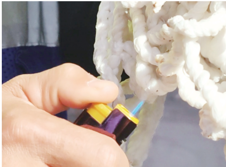
打火机的火苗在舔舐防坠网网面。
