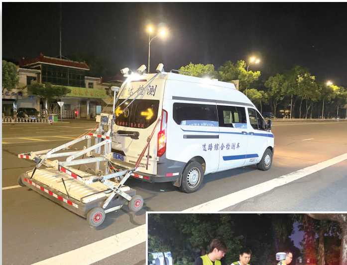
▲三维雷达探测车在湖心中路扫描路基。
