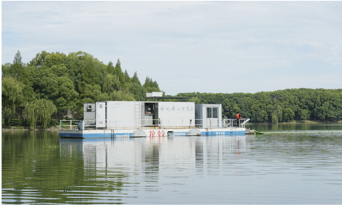
藻水高效气浮分离船正在西小湖上作业。 通讯员 潘建 摄
