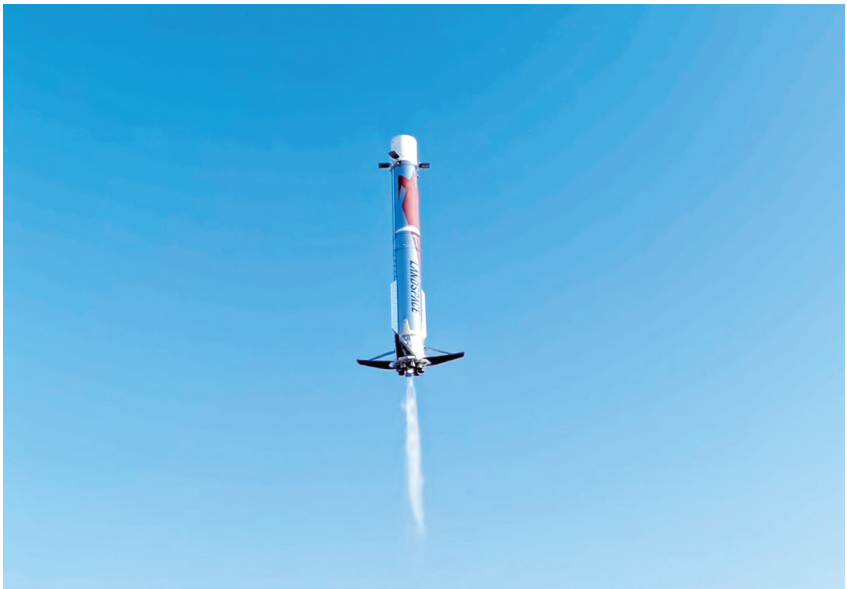
这张2026年8月19日的视频截图显示,朱雀三号遥二运载火箭一子级在着陆过程中展开着陆支腿。此次任务是我国首次成功实施重复使用运载火箭一子级着陆腿方式回收,标志着我国重复使用火箭技术取得重大突破。
